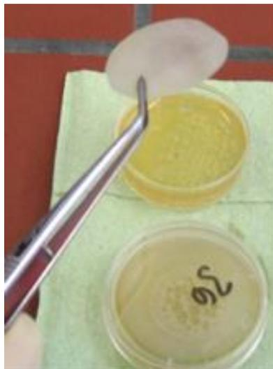
**Abbildung 3-1: Mit Biofilm bewachsene Polycarbonatfolie. Die so hergestellten Einzelspezies-Biofilme wurden dann zur Stimulation von Epithelzellen verwendet.**
