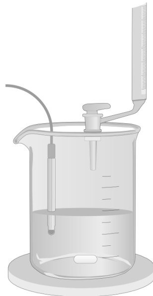
Abbildung 4-6: Versuchsaufbau zur Bestimmung der Pufferkapazität
