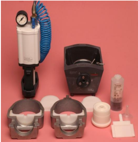
Fig. 4 – A: SR Ivocap injection system
