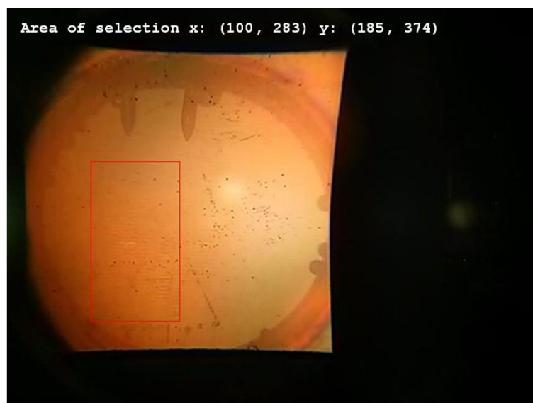
Abbildung 5.20: Aufgenommenes Bild bei der Brechungsindexmessung mit dem telezentrischen Optikaufbau und Smartphone. Der ausgewählte Bereich für die Messung ist als rotes Rechteck markiert.
