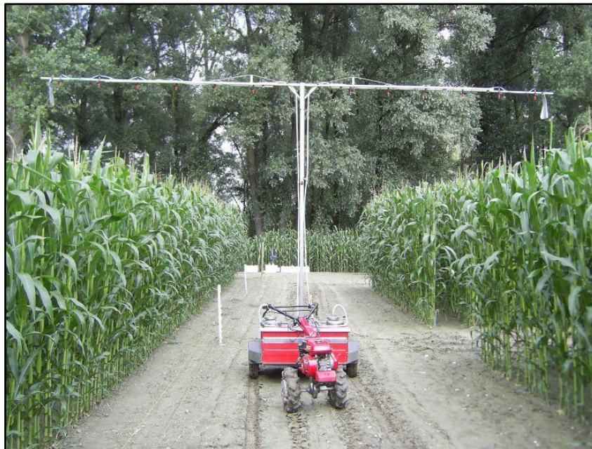
Abb. 13: Neu entwickelte Versuchsspritze zur Applikation von Mais in einem Bereich von 0,7 bis 4,0 m Höhe
