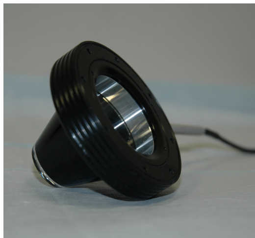
Abb. 2: Kontaktglas-Dynamometer, Firma Meditron GmbH, Völklingen. Goldmann-Dreispiegelglas mit Drucksensor im Haltering.
