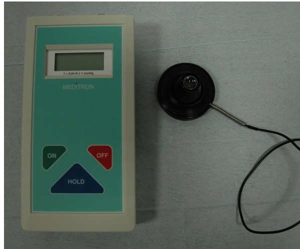
Abb. 3: Kontaktglas-Dynamometer, Firma Meditron GmbH, Völklingen. Goldmann-Dreispiegelglas mit Zentraleinheit abgebildet.
