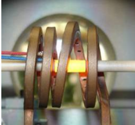
Abbildung 4.4.: Aufgeheizte zylindrische Probe innerhalb der modifizierten Heizspule. Um sowohl den Primärstrahl als auch das Streusignal passieren zu lassen, ist eine Wicklung aufgeweitet.
