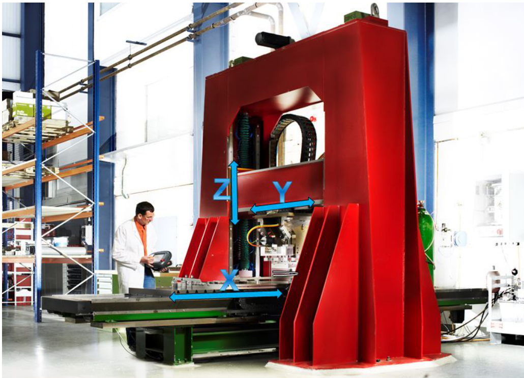
Abbildung A.19.: Portalanlage am Helmholtz-Zentrum in Geesthacht, die wegen ihres stabilen Rahmens (rot) für das Rührreißschweißen von Stählen genutzt wird. Mit freundlicher Genehmigung vom Helmholtz-Zentrum Geesthacht.
