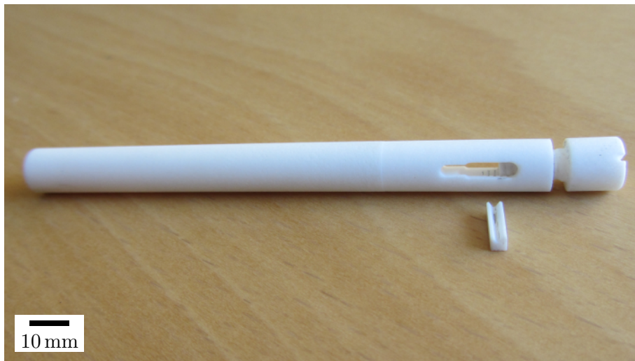
Abbildung 3.6: Fotografie des Hochtemperatur-Probenhalters mit Klemmung der Probe mittels einer Schraube. Der gekerbte Einsatz verhindert eine Beschädigung der Probe durch die Drehbewegung beim Anziehen der Schraube und zentriert die Probe in der Aufnahme. Alle Teile bestehen aus Macor und sind für Messungen bis 800 °C geeignet.
