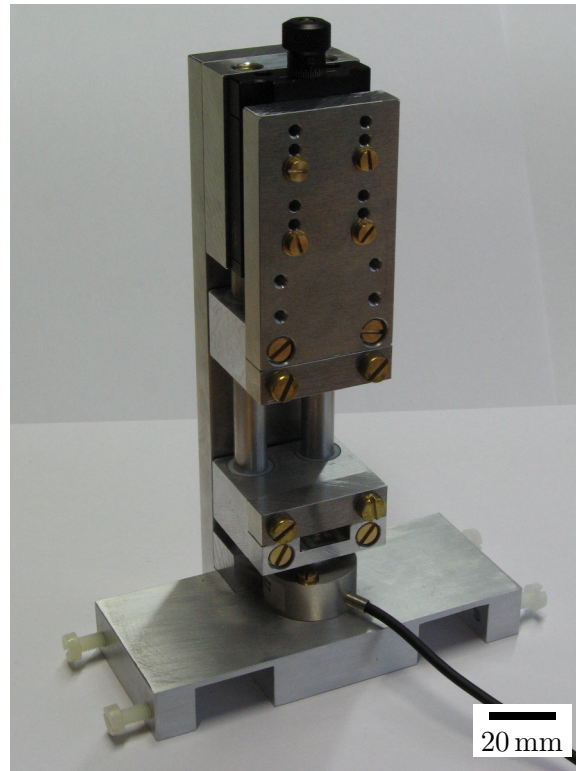
Abbildung 3.15: Fotografie der manuellen Zugprüfung mit (von unten nach oben) Basisplatte, Kraftmessdose, Gleitern mit Klemmbacken und Lineartisch. Die Verbindung vom oberen Gleiter zum Lineartisch erfolgt über eine Adapterplatte, die in drei Positionen befestigt werden kann.
