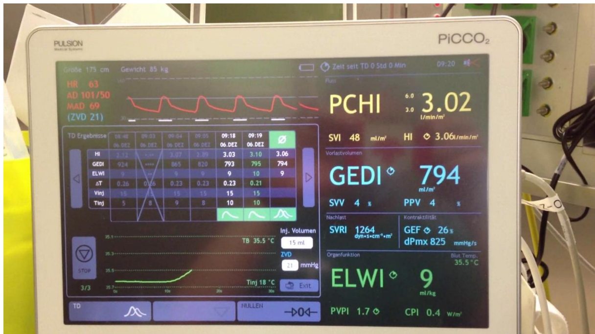
Abbildung 6: PiCCO 2 -Monitor mit arterieller Druckkurve, Pulsconturanalyse und Thermodilutionskurve; Arterieller (AD) und mittlerer arterieller Blutdruck (MAD) via A. femoralis; Herzindex durch Pulsconturanalyse (PCCI); Herzindex durch transkardiopulmonale Thermodilution (CI); Schlagvolumenindex (SVI); dynamische Vorlastvariablen: Schlagvolumenvariation (SVV) und Pulsdruckvariation (PPV); systemischer vaskulärer Widerstandsindex (SVRI); volumetrische Parameter: Globaler end-diastolischer Volumenindex (GEDI) und Extravaskulärer Lungenwasserindex (ELWI)
