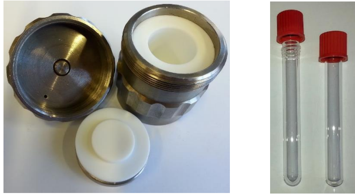
Abb. 1: Stahlautoklav mit Tefloneinsatz, 20 mL Volumen (links), Glasreaktoren aus Borosilicatglas mit 9 mL Volumen (rechts).
