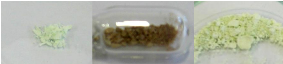
Abb. 48: [\text{Ni}_3(\text{PPT})(\text{H}_2\text{O})_3] \cdot 12\text{H}_2\text{O} : Links: nach der Synthese, Mitte: für 16 Stunden unter reduziertem Druck aktiviert, Rechts: nach Aktivierung in Wasser gerührt.
