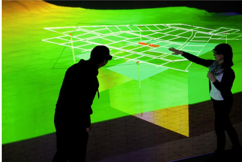
Abbildung 7-3: Beispiel der dreidimensionalen Visualisierung: Wohngebiet in Taucha mit weiß gekennzeichneten Grundstücksgrenzen und rot dargestellten Ansatzpunkten für die potentielle Installation von Erdwärmesonden sowie den Ergebnissen der standortspezifischen Untergrunderkundung.
