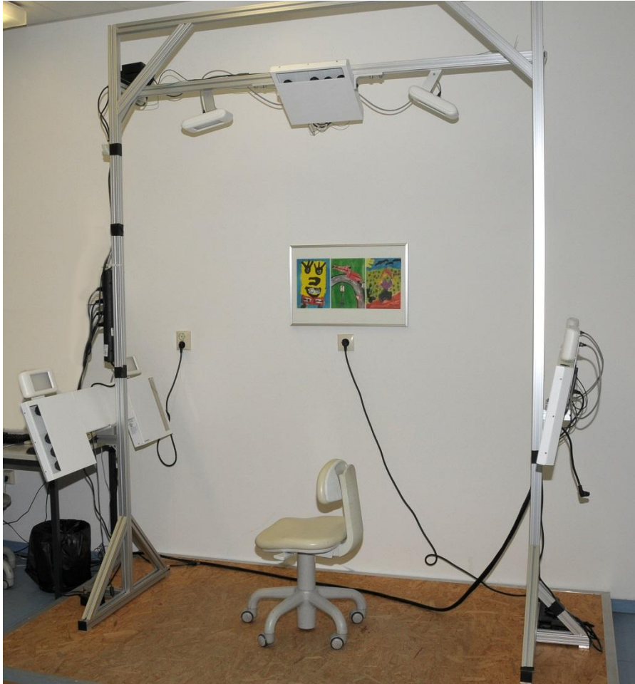
Abbildung 3. Darstellung des VECTRA® 3D Imaging System, hergestellt von Canfield Imaging Systems (USA), der Foto-Abteilung des Universitätsklinikums Kiel für Zahn-, Mund- und Kieferheilkunde
