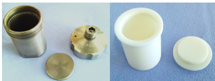
Abb. 2.1.1 Stahlautoklav (links) mit Teflonreaktor mit einem Füllvolumen von ca. 30 mL.
