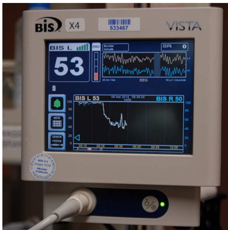
Abbildung 3: BIS VISTA™-Bilateral-Monitoring-System (Aspect Medical Systems, Norwood, MA, USA) während Messung unter Allgemeinanästhesie. Oben links im Bildschirm befindet sich die Anzeige des ausgewählten BIS-Wertes („R“ für die rechte und „L“ für die linke Gehirnhälfte). Rechts neben der BIS-Wertanzeige ist der Signalqualitätsindex (SQI) als Balkendiagramm dargestellt (fünf grüne Balken bedeutet eine gute Signalqualität). Der Elektromyogramm-Balken (EMG) zeigt die EMG-Aktivität an. Im kleinen Anzeigebereich oben rechts sind zwei EEG-Kurven, gelb für die Ableitung der linken Gehirnhälfte und blau für die Ableitung der rechten Gehirnhälfte dargestellt. In der unteren Bildschirmhälfte werden, entsprechend den abgeleiteten Gehirnhälften, die Kennzeichnungen „R“ für rechtsseitige BIS-Werte bzw. „L“ für linksseitige BIS-Werte, sowie die entsprechenden Verlaufskurven, gelb für links und blau für rechts, angezeigt.
