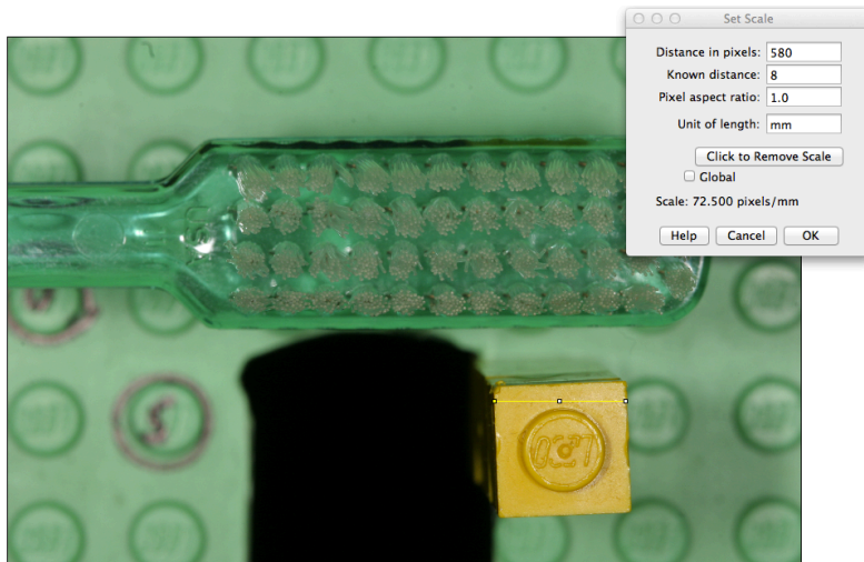
Abb. 9: Prozess des Kalibrierens im Bildverarbeitungsprogramm Image J (ImageJ, Wayne Rasband, NIH, public domain)
