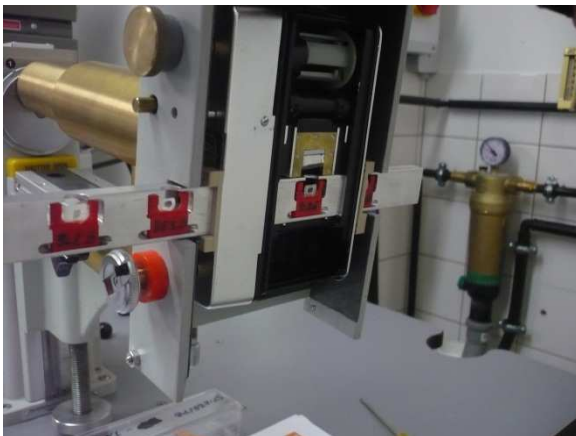
Abb.32 Proben in TMR-Gerät mit noch geöffneter Klappe
