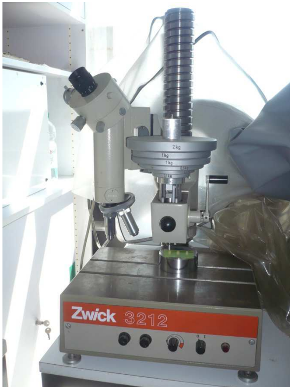
Abb.8 Universalprüfmaschine mit Knoophärte-diamant zur Einbringung von Impressionen in die Wurzel-dentin-segmente
