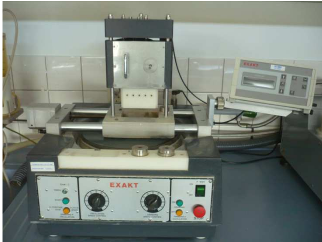
Abb.29 Planparallelschleifteller zur Herstellung von exakt 100\mu\text{m} dünnen Probenscheiben
