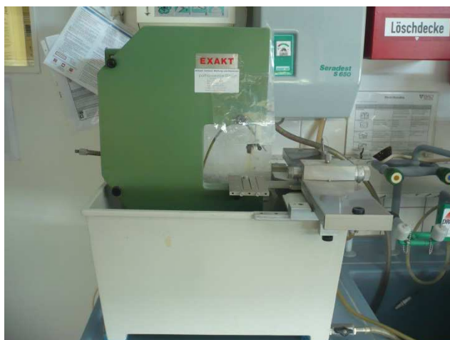
Abb.28 Präzisionsbandsäge mit Vakuumhalterung zur Gewinnung von Dünnschnitten der Dentinproben
