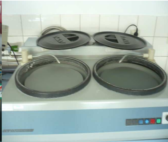
Abb.2 Schleifteller mit Schleifpapier zur Schaffung einer planen Auflagefläche
