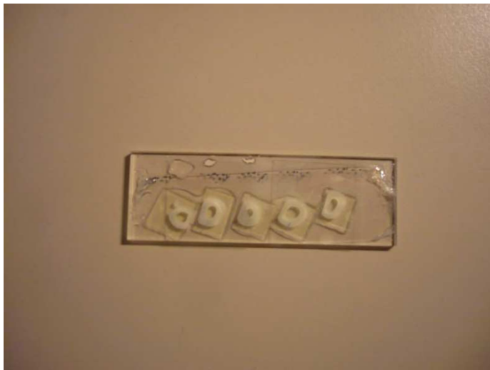
Abb.39 Proben auf Objektträger mit Mikroskopierplättchen feucht gehalten
