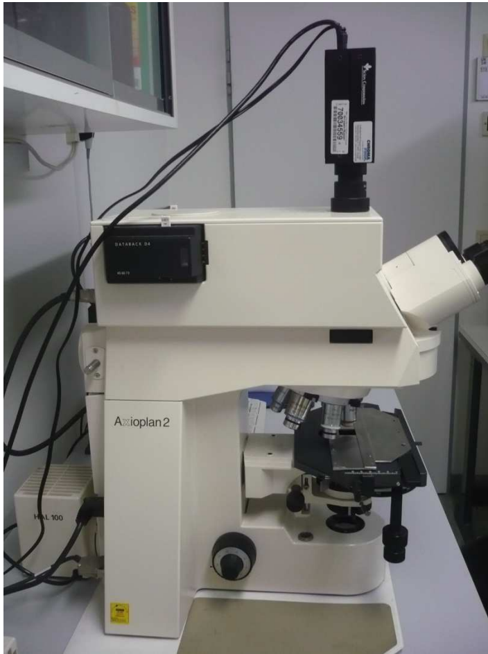
Abb.34 Axioplan 2 mit CCD Kamera mit deren Hilfe die TMR Filme digitalisiert wurden
