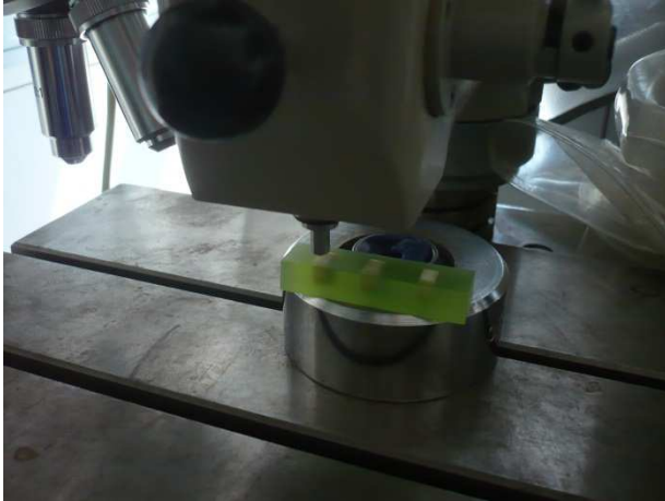
Abb.11 Universalprüfmaschine mit planparallelen Dentinprobenblock beim Setzen einer Impression
