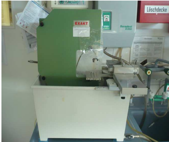
Abb.1 Präzisionssäge zum Zerteilen der bovinen Wurzeln
