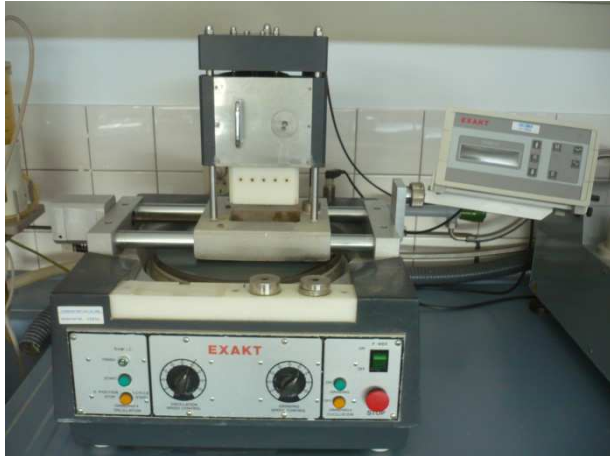
Abb.6 Planparallelschleifer zur Planparallelisierung der bov. Wurzelentinssegmente
