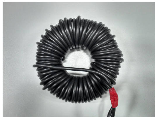
Abb. 10.7: Phasendrossel des 3PiTSS mit 113 Wicklungen und einem Ringkern „T520-34“ von Micrometals mit L_i = 830 \mu\text{H}
