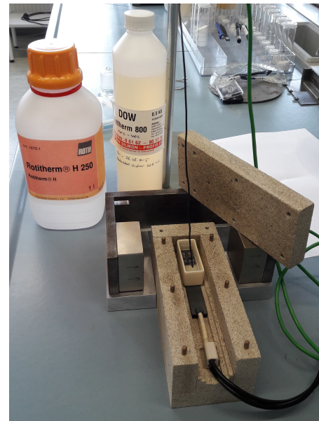
Abbildung 3.6: Aufbau zum Magnetfeldtempern in Öl. Silikonöl von Rotitherm H 250 für Temperaturen bis 250 ^{\circ}\text{C} , Öl von DOW Syltherm 800 für Temperaturen bis 400 ^{\circ}\text{C} .
