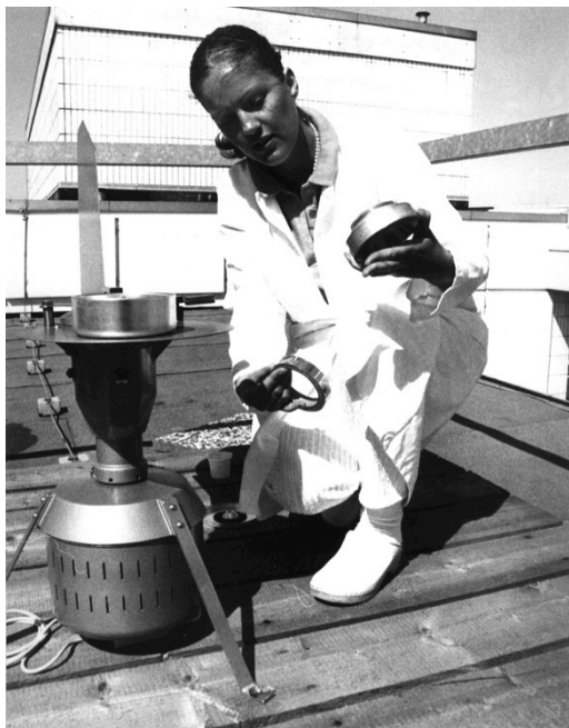
Abb. 4: Burkhard Pollenfalle auf dem Dach der Universitätshautklinik in Kiel (Schleswig-Holstein) zeigt Frau Prof. Fölster Holst als Assistenzärztin bei der Entnahme des Streifens zur mikroskopischen Analyse der Pollen, 1987
