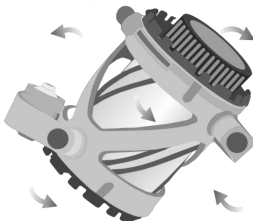
Abbildung 4-2 - Schematische Zeichnung des Turbula®-Mischers.
