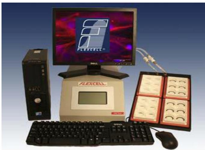
**Abbildung 2-12:** Flexcell @5000TMTension System. Mithilfe dieser Dehnungsapparatur kann eine mechanische zyklische Dehnung auf Zellen ausgeübt werden, welche dem biomechanischen Stress in „*in vivo*“ Bedingungen sehr ähnlich ist.
