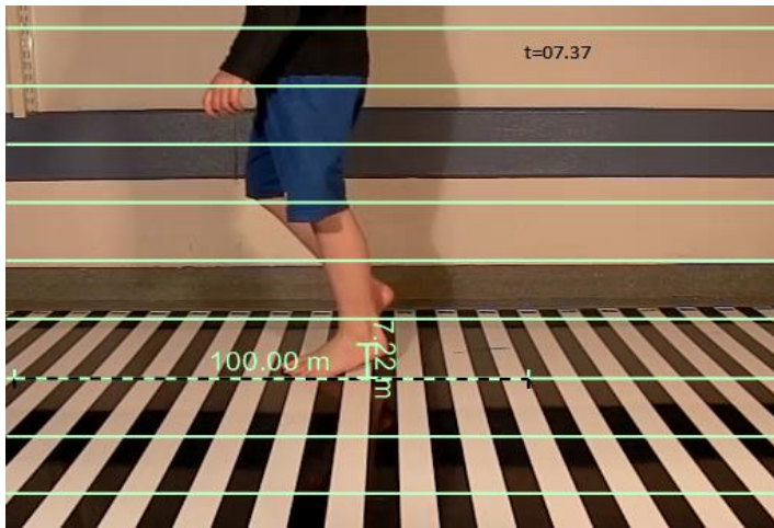
Abbildung 10: Beispiel Messung Ferse-Boden-Abstand
