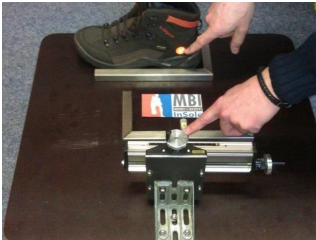
Abbildung 6: Instrument zur reproduzierbaren Positionsmarkierung eines Markers am Schuh
