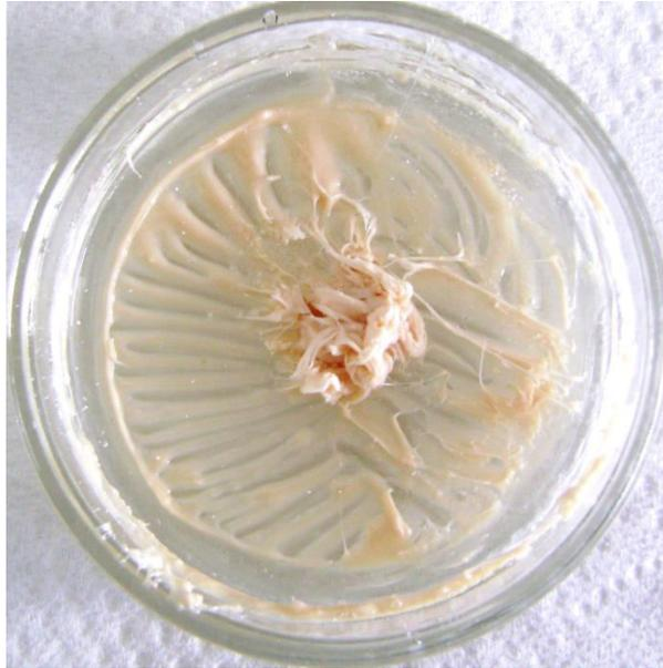
**Abbildung 41: Verdunklung der Mischung aus Risperidon und PLGA aufgrund der übermäßig hohen Heiztemperatur des Polymers bei 180 °C [Beispiel hier: PLGA 75:25 mit 20% Risperidon]**
