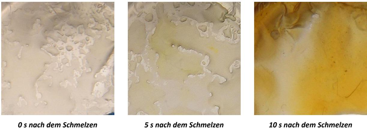
**Abbildung 22: Farbverhalten des Arzneistoffes Risperidon direkt nach dem Schmelzen bei 170 °C auf einer Heizplatte**
