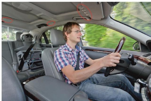
Abbildung 2.1: Ein mit dem vorgestellten ICC-System ausgestattetes Testauto der CAU Kiel. Sichtbare Mikrophone des Systems sind rot eingekreist. (vgl. [48, S. 99])
