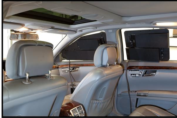
Abbildung 4.2: Die an den Innenseiten der rechten Autofenster angebrachten Lautsprecher der akustischen Umgebungssimulation. ([26, S. 196] und [38, S. 479])
