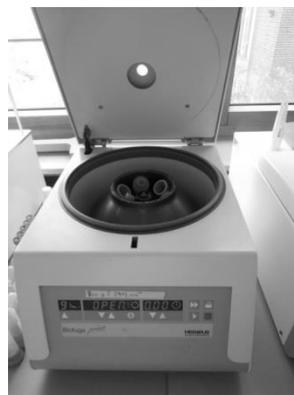
Abbildung 6: (a, links) Inkubator/Brutschrank zur Kultivierung der Zellen; (b, rechts) Zentrifuge zum Trennen der Zellen von der Suspension
