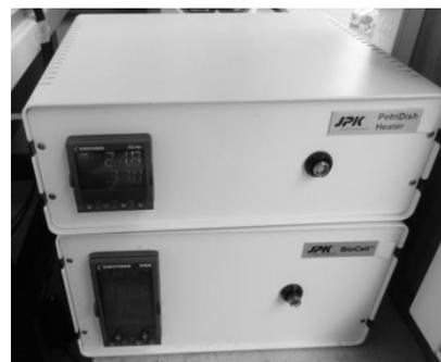
Abbildung 12: (a, links) Petrischale mit 3 Dentinprobekörpern im AFM; (b, rechts) PetriDish Heater zum Erwärmen des CO<sub>2</sub> unabhängigen Mediums in der Petrischale auf 37 °C
