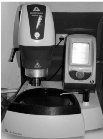
Abbildung 3: Schleifmaschine AutoMet 250 zur Aufbereitung der Oberflächenrauigkeiten aller Probekörper, mit Ausnahme der maschinerten und polierten Oberflächen des Zr und ML
