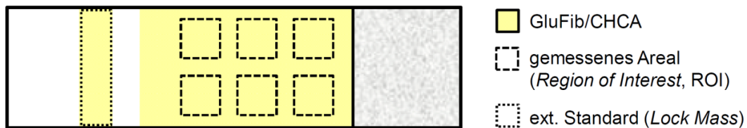
Abbildung 6: Experimenteller Aufbau für die Untersuchung der Stabilität der Massengenauigkeit.
