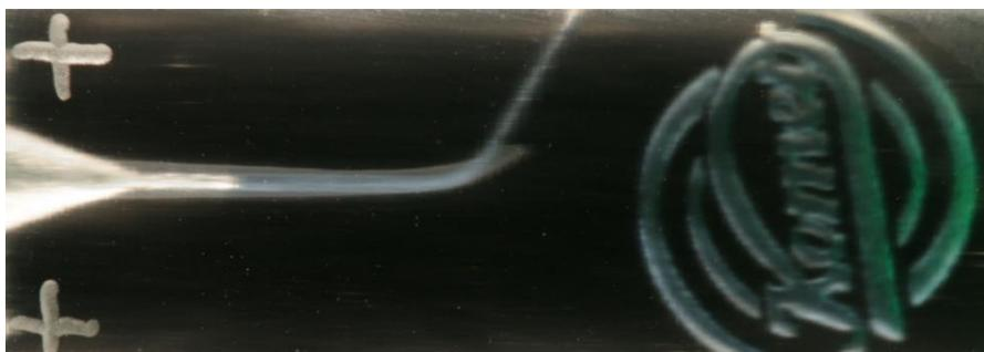
Abbildung 22: Stufenbildung Reciproc-Gruppe (25/08), Kanalkonfiguration: 60R2
