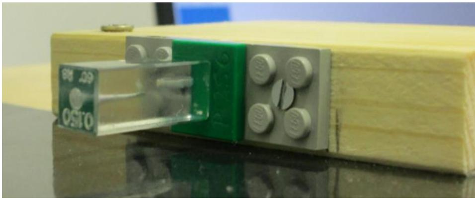
Abbildung 11: Fixierungsvorrichtung mit Untersuchungsblock
