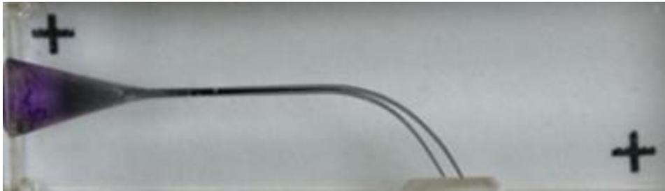
Abbildung 5: Darstellung der auftretenden Abweichungen innerhalb einer Kanalkonfiguration bei der Fertigung der Kunststoffblöcke mittels herkömmlicher Herstellungsverfahren
