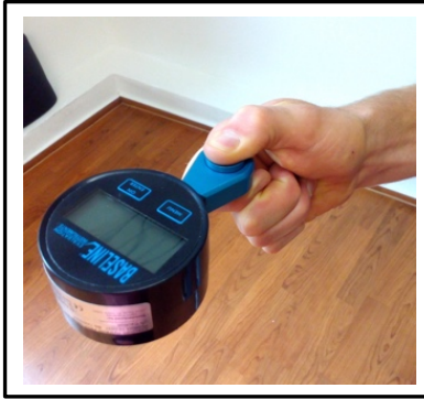
Abbildung 17. Fingerkraftmessung Baseline Digital Pich Gauge
