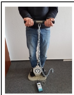
Abbildung 20. Hubkraftmessung - Baseline Bag-Leg-Chest Dynamometer in Kombination mit DigiMax Messgerät
