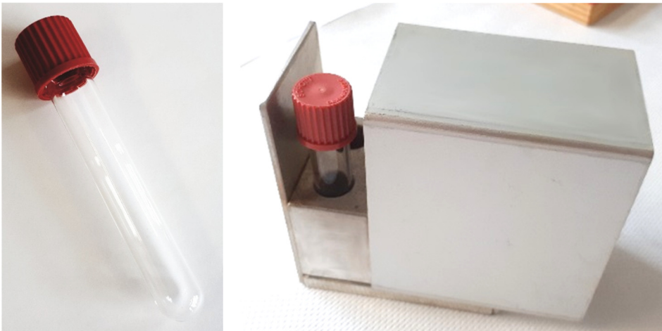
Abbildung 15: Duran©-Kulturröhrchen (links) und im Aluminiumblock (rechts).
