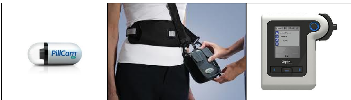
Abb.4: PillCam SB3- Dünndarmkapsel (Größe 26x11mm, adaptive Bildfrequenz mit 2-6 Bilder/sec, Mindestfunktionsdauer 12h) mit Sensorengürtel und Datenrecorder DR3 mit Real-Time Viewer (Quelle: Given Imaging).
