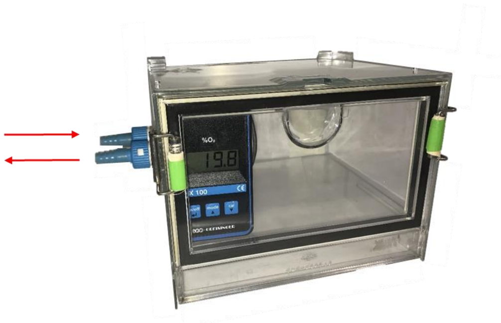
Abb. 2.2: SICCO Mini 1 Exsikkator der Firma Bohlender GmbH. Über die beiden Ventile (links) kann gasförmiger Stickstoff eingeleitet und Raumluft abgeleitet werden. Die Kammer wird über die grünen Bügel luftdicht verschlossen. Das Sauerstoff-Messgerät im Inneren gibt die aktuelle O 2 -Konzentration in der Kammer an.
