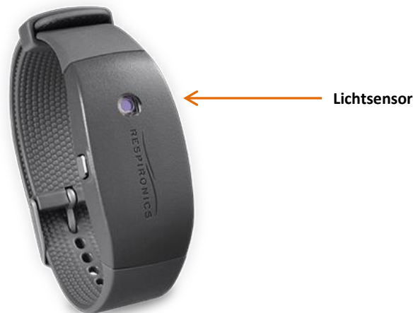
Abb. 13: Actiwatch 2 mit Lichtsensor.[URL 7]
