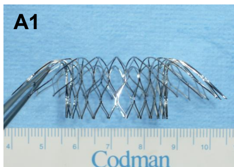
A: Fotos: Ansichten des Nitinol-Gerüsts, ventrikulärer Körper (A1) und atrialer Kranz (A2)
