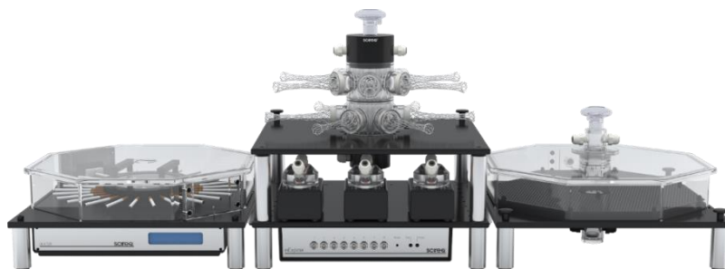
Abb. 2.2: InExpose -Rauchmaschine der Firma SCIREQ ® . Links befindet sich das Zigarettenkarussell, rechts eine Expositions-kammer. Erhöht in der Mitte ist ein nose-only-tower zu finden, der bei Versuchen mit Mus musculus Anwendung findet, jedoch im Fall von Versuchen mit Drosophila durch eine weitere Expositions-kammer ersetzt wird. 107
