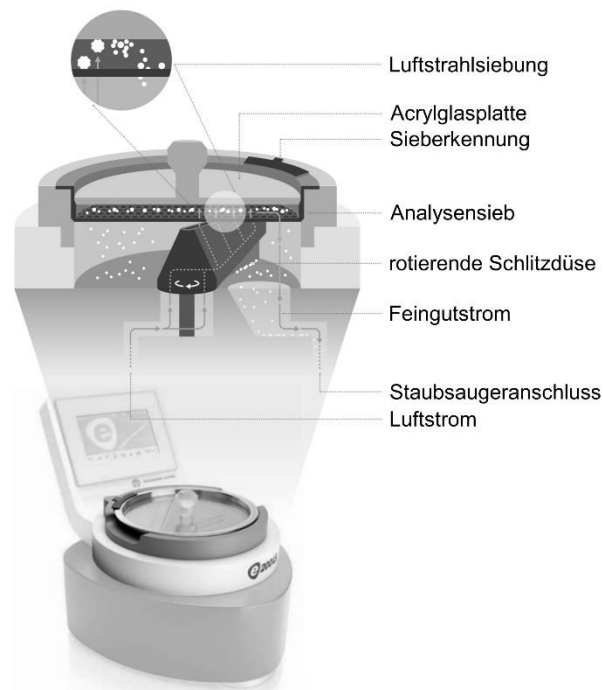
Abbildung 4-3: Luftstrahlsieb e200 LS mit schematischer Darstellung des Funktionsprinzips [125]
