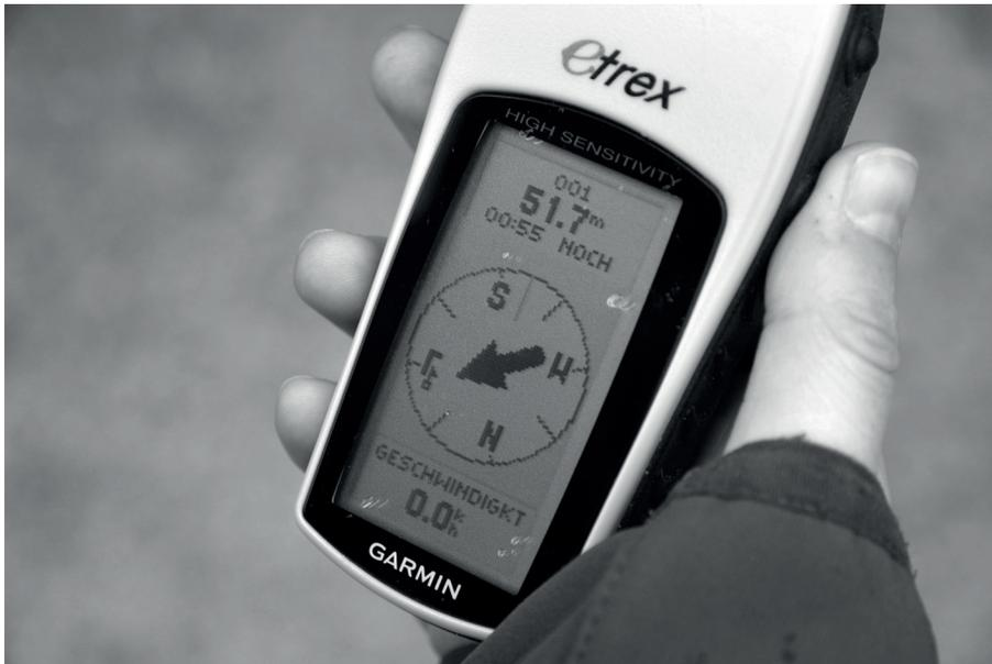
Abb. 16: Ein einfaches GPS-Gerät dient zur Auffindung der geographischen Koordinaten eines Geocaches
