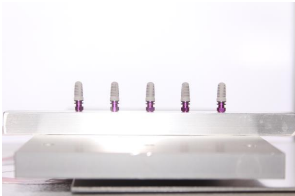
Abbildung 2: Dentale Titanimplantate der Firma Camlog (SCREW-LINE Implantat, Promote plus) in einer Aufnahmevorrichtung zur Plasmakonditionierung
