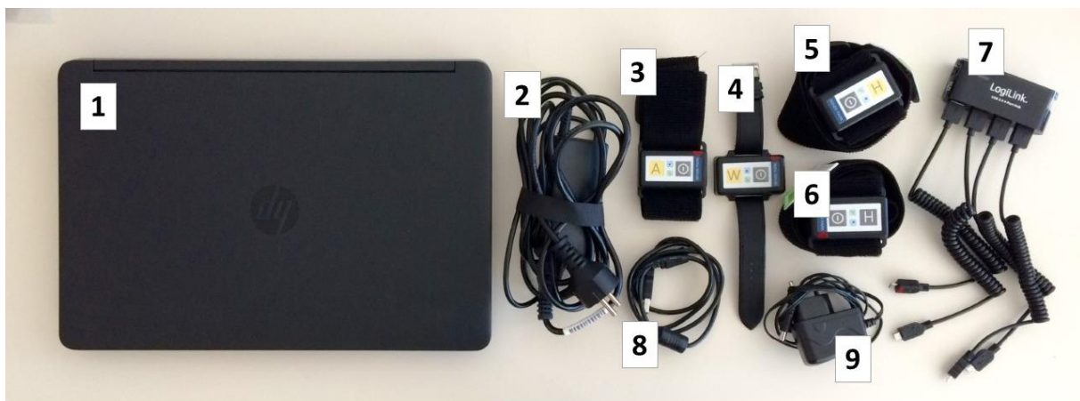
1 = Laptop, 2 = Ladekabel für den Laptop, 3 - 5 = Tagsensoren, 6 = Nachtsensor, 7 = USB Port und Ladekabel für die Sensoren, 8 = USB Kabel zwischen Laptop und dem USB Port, 9 = Ladekabel für den USB Port
