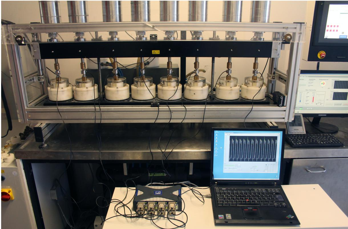
Abb. 15: Kausimulator mit Messeinrichtung.
