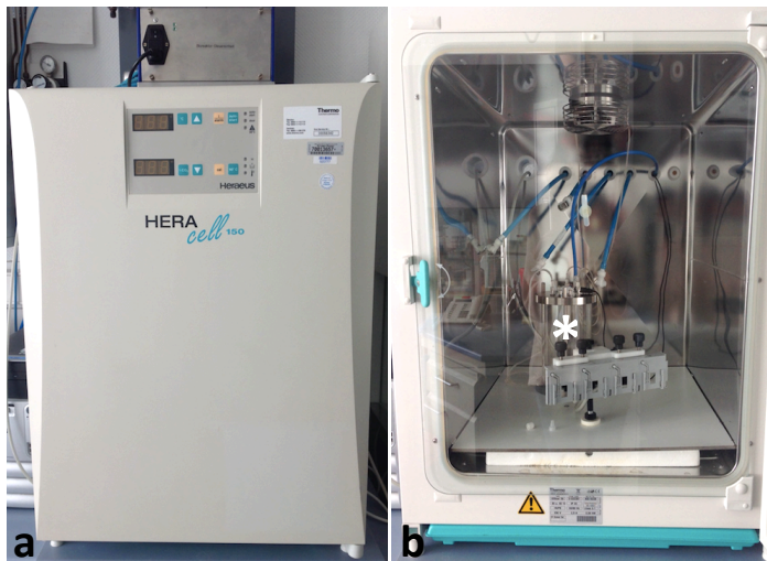
Abb. 27: Bioreaktor für dynamische Zellkultivierung (a) Bedienfeld und Steuerelement (Pfeile); (b) Bioreaktor mit Einspannvorrichtung (Stern)
