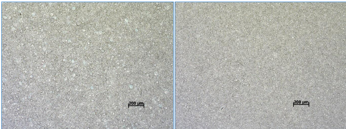
Abbildung 61. Vergleich des Sprühergebnisses der Düse „A70-1kV“ bei einer Verfahrensgeschwindigkeit von 11 \text{ mm}\cdot\text{s}^{-1} (links) und 8 \text{ mm}\cdot\text{s}^{-1} (rechts) bei einem Düsenabstand von 3 cm und einem Sprühdruk von 7 bar. Das Sprühmedium entspricht dem Mischungsverhältnis für die aktive Schicht einer organischen Photodiode (P3HT:PCBM:CB (1:0,75:98,25)).
