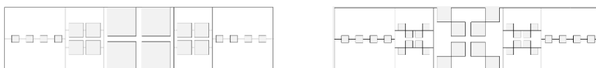
Abbildung 72. Waagerechte Darstellung der Justiermarken der zweistufigen Düsenmasken V1 (links) und V2 bis V4 (rechts). Zum besseren Verständnis sind mit Chrom bedeckte Bereiche auf der Maske in einem hellen Grauton eingefärbt.
