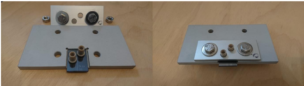
Abbildung 27. Klemmvorrichtung zur Anbindung der Sprühdüsen über Fluidports. In die Fluidports lassen sich PFA-Schläuche einschrauben und Sprühdrukke von bis über 7 bar anlegen.
