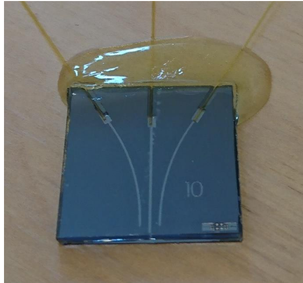
Abbildung 25. Mikrosprühdüse mit eingeklebten Glaskapillaren. Es ist zu sehen, dass der Kleber die Anschlussbereiche etwa zur Hälfte füllt. Mittig auf dem Borosilikatglas sind leichte vertikale Spuren anionischer Bestandteile zu erkennen, die beim anodischen Bonden zur Elektrode wandern (hier wurde eine Elektrode in Sternform verwendet).
