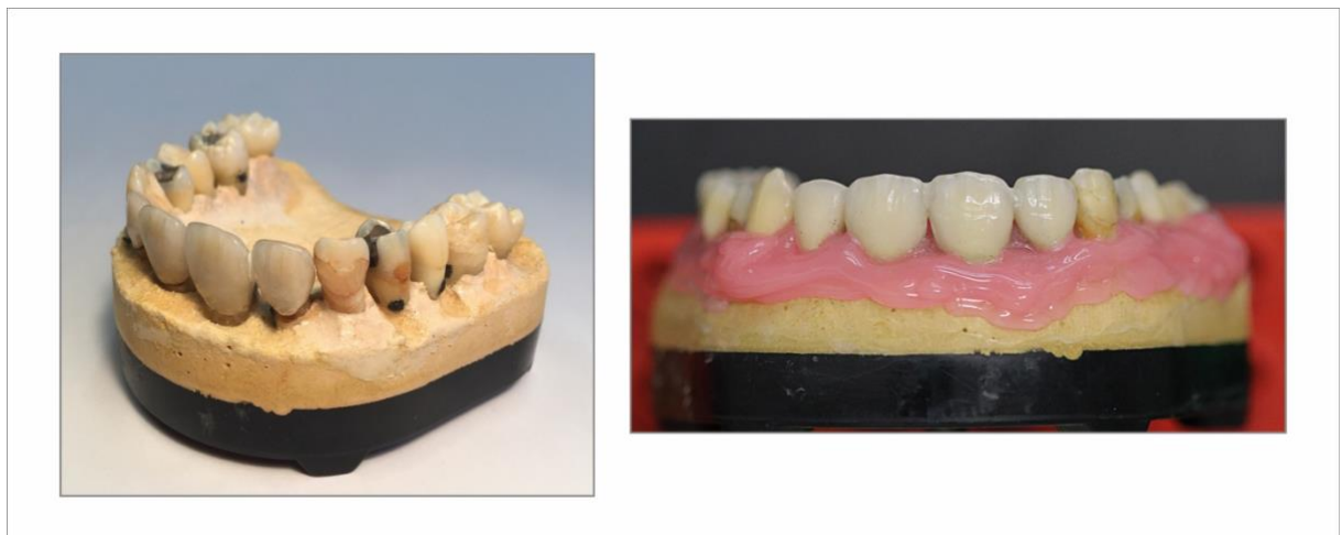
Abbildung 3-7: Oberkiefer Echtzahnmodell links mit aufgebrachtten artifiziellen Konkrementen und rechts mit darüber positionierter Zahnfleischmaske
