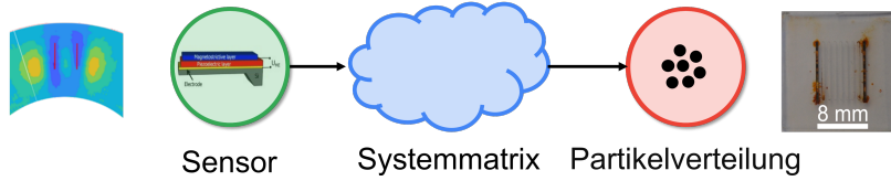
Abbildung 3.6: Mit dem Sensor kann das Feld, das von einer Partikelverteilung ausgeht, gemessen werden. Das gemessene Feld und die Partikelverteilung sind über eine Matrix miteinander verbunden. Diese Matrix wird als Systemmatrix bezeichnet und enthält Informationen dazu, wie Partikel an einem Ort im Probenraum zum gemessenen Feld beitragen.
