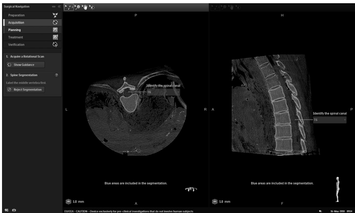
Abbildung 9: Identifikation des 3D-Datensatzes durch die Software. Die einzelnen Segmente werden von der Software erkannt. Der Operateur muss nun bestimmte anatomische Landmarken festlegen, wie hier im Bild die Mitte des Spinalkanals auf einer bestimmten Höhe (BWK 6).
