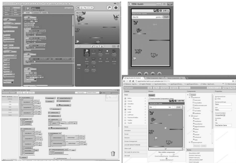
Abb. 1.: Scratch (o.l.) im Vergleich mit App Inventor: Blocks Editor (u.l.), App Inventor Designer mit Komponenten (u.r.) und Emulator (o.r.)
