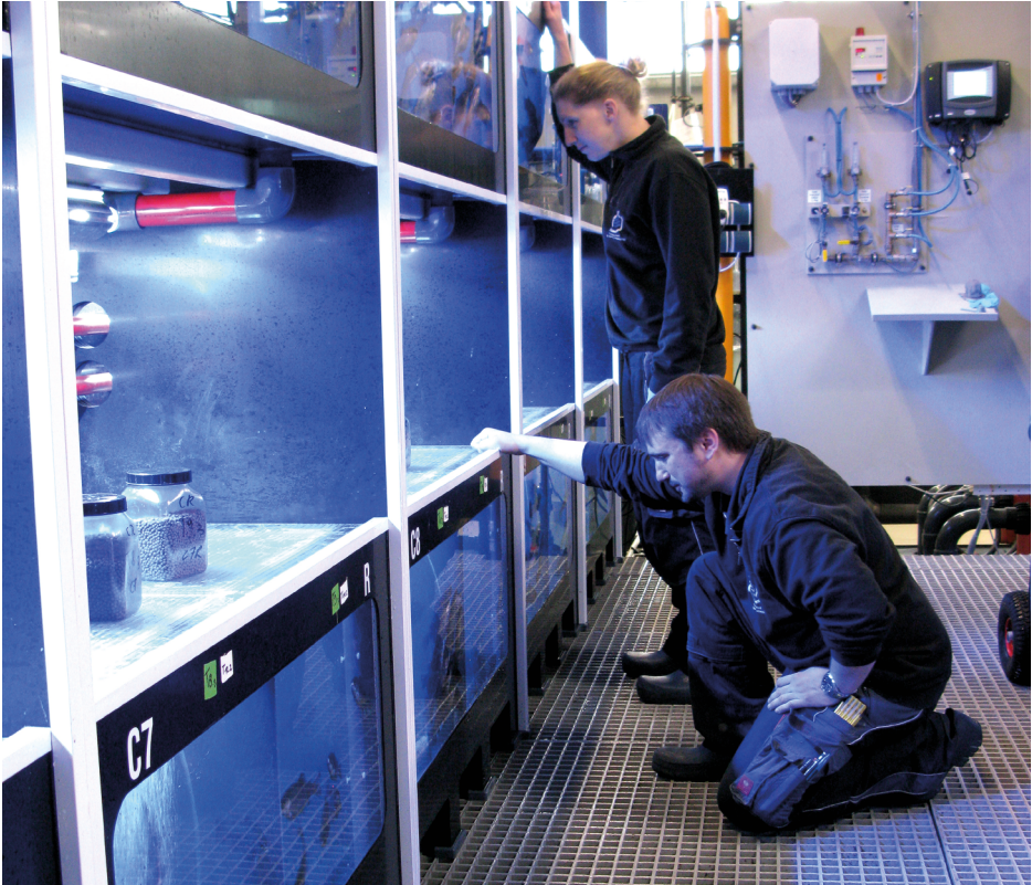
Abb. 47: Insgesamt stehen 12 Versuchskreislaufsysteme unterschiedlicher Größe mit insgesamt ca. 250 Versuchsbecken und- aquarien zur Verfügung. Hier ein Versuchskreislauf mit 30 Einzelbecken. Quelle: C. Schulz.
