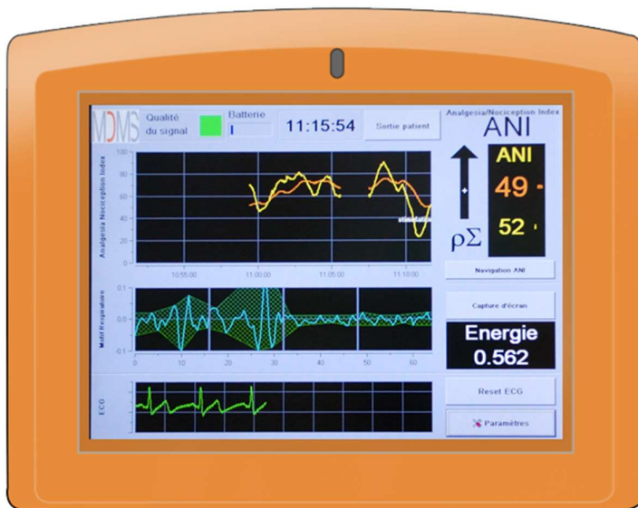
Abbildung 2: Der Analgesia Nociception Index (ANI) Monitor.
