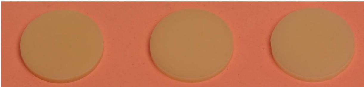
*Abbildung 9: Probenkörper des 4YSZ nach Fertigstellung, von links nach rechts: bei 1400°C gesintert, bei 1500°C gesintert, bei 1600°C gesintert*
