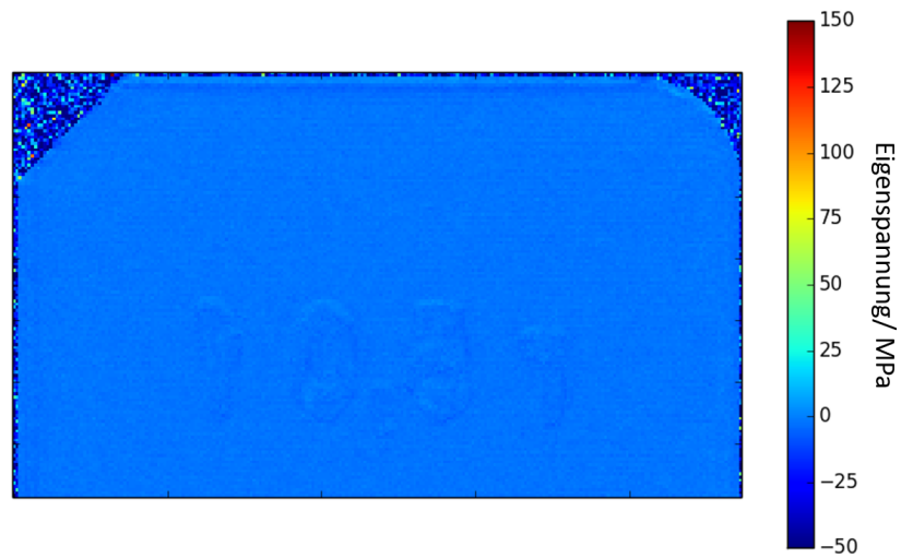
Abbildung 58: Darstellung des Differenzbildes einer Probe mit einer Fase und Rundung von 5 mm. Dabei wird das Ergebnis einer in dieser Arbeit vorgestellten Technik verwendet und davon das Ergebnis des von der Arbeitsgruppe Keckes verwendeten Verfahrens abgezogen.
