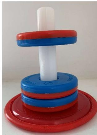
**Abbildung 4.4:** Ringmagnete auf einer Führung
