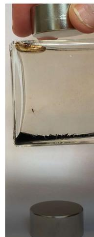
**Abbildung 4.3b:** Ein Magnet unter einer Ferrofluidflasche und ein Magnet darüber mit geringem Abstand
