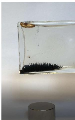
**Abbildung 4.3a:** Ein Magnet unter einer Ferrofluidflasche und ein Magnet darüber mit großem Abstand (nicht sichtbar im Bild)
